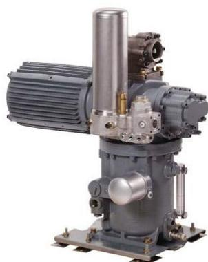
2. Моноблочная схема компоновки. Винтовой блок смонтирован прямо на маслобаке, что снижает внутреннее сопротивление системы и исключает применение дополнительных маслопроводов.
